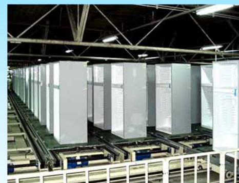
冷蔵庫組立設備
